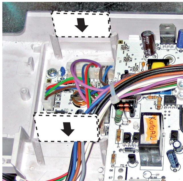
**(i)** Sguainare i conduttori per 40...50 mm, quindi spelare le estremità per circa 5 mm. Inserire con precisione i conduttori **evitando la presenza di eventuali filamenti liberi dei conduttori che potrebbero causare cortocircuiti** tra i morsetti del BUS Cascata.
